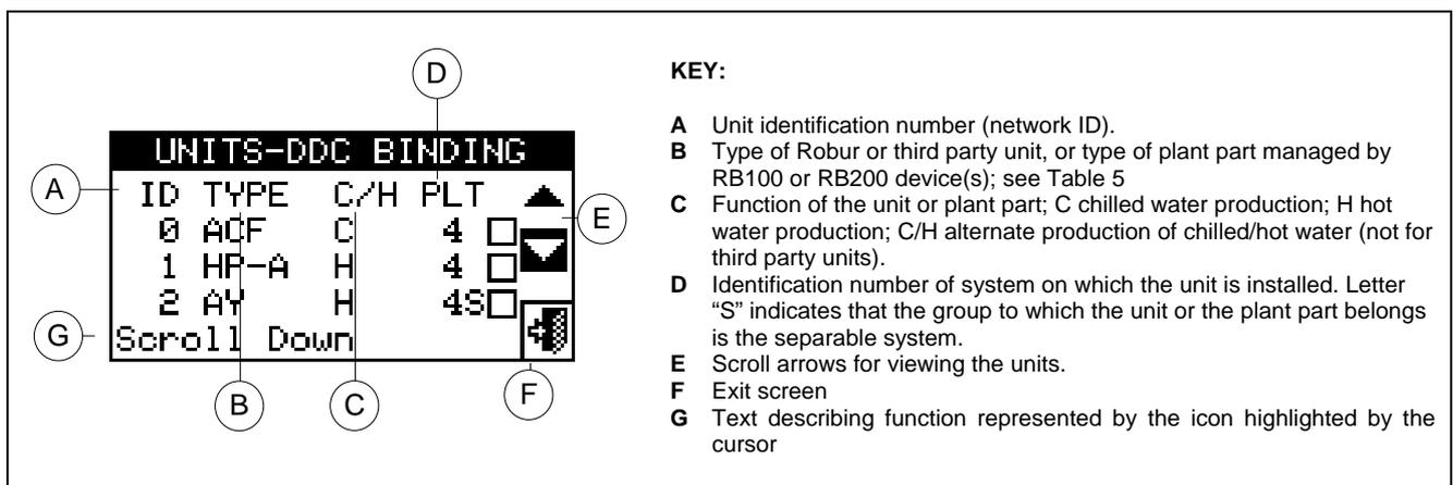
Figure 17— EXAMPLE OF MACHINE CONFIGURATION MENU SCREEN
