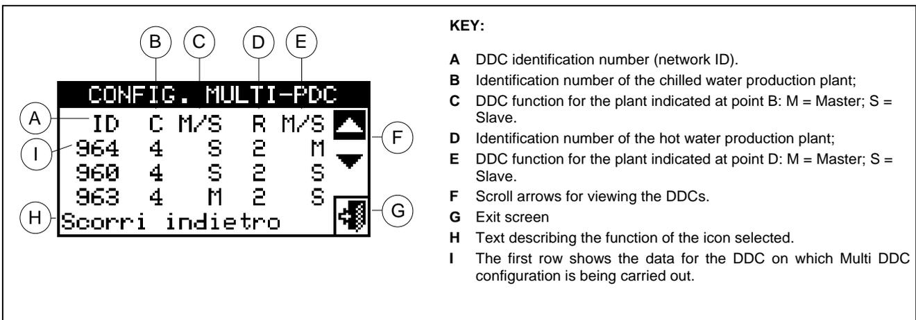
Figure 18 – EXAMPLE OF MACHINE CONFIGURATION MENU SCREEN
